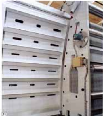
9. Vista generale di una rotativa rotocalco modello Rotomec 3000-3R. 10. Camera d'asciugamento. L'apertura laterale delle cappe consente un'agevole introduzione del nastro ed una facile pulizia delle soffiere e dei rulli. 11. Soffiere di mandata ed aspirazione.
