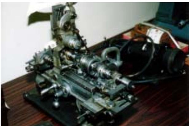
しかし、ミニ工作機械は今始まったことではない。実は、時計工場ですでに写真に示すような立派なミニ工作機械が使用されていたのである。しかも、一部の工作機械は全体のサイズが一辺 200mm
