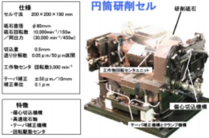
これには新しい形式の工作物支持装置及び切り込み装置(次図)を装着した。偏心機構による切込みを行う方式であり、直線運動を全く利用していない新しい設計(特
