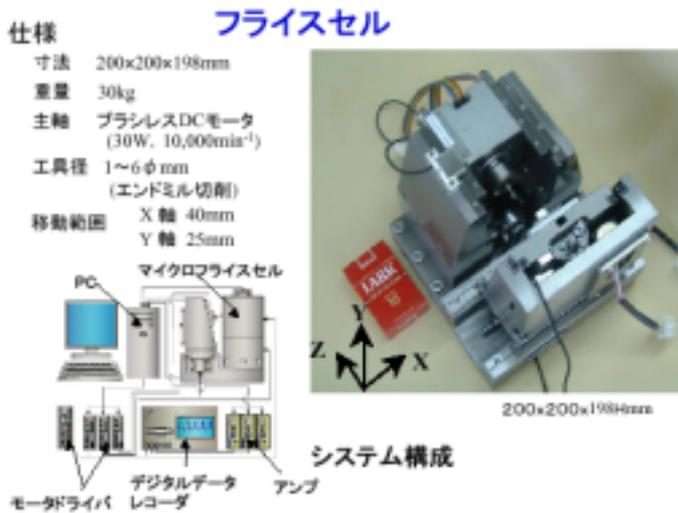
また、ミニフライセルはモジュール構成となっており、基本設計にあるように、一部の変更でミニ切削加工セルに変身できる構成になっている(下図参照)。切削実験、精度測定の結果、十分実用化に耐えうることが分かった。
